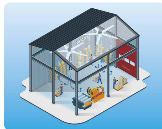
Aumenta el efecto de la evaporación en la piel y reduce la sensación térmica hasta 6°C
